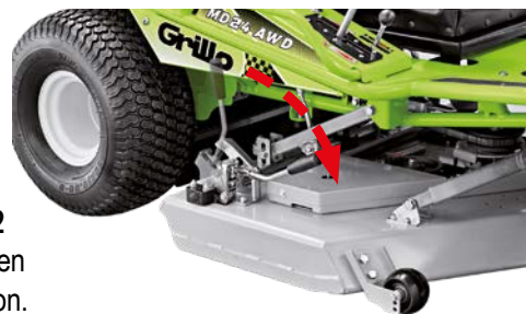
Heckauswurf: offene Schnittkammer Mulch-Modalität: geschlossene Schnittkammer
