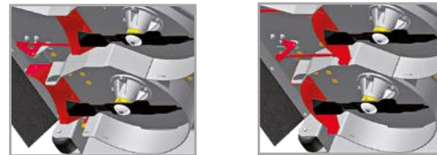
Heckauswurf: offene Schnittkammer Mulch-Modalität: geschlossene Schnittkammer
