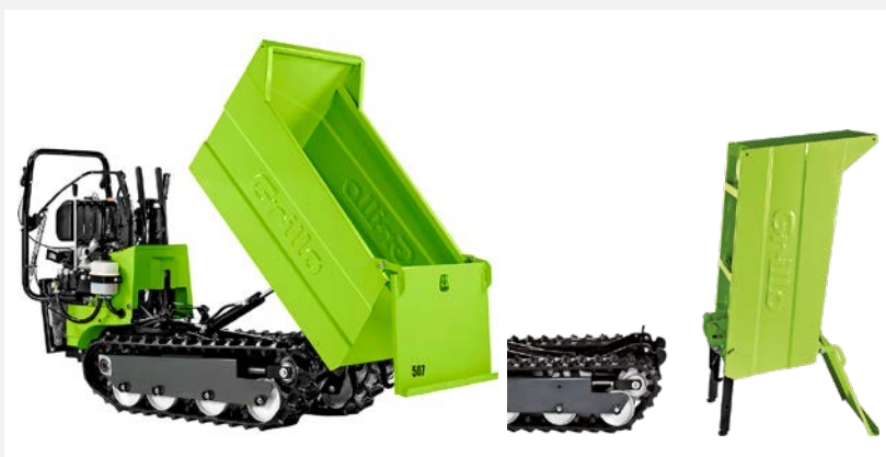
Kit ribaltamento idraulico per cassone.
